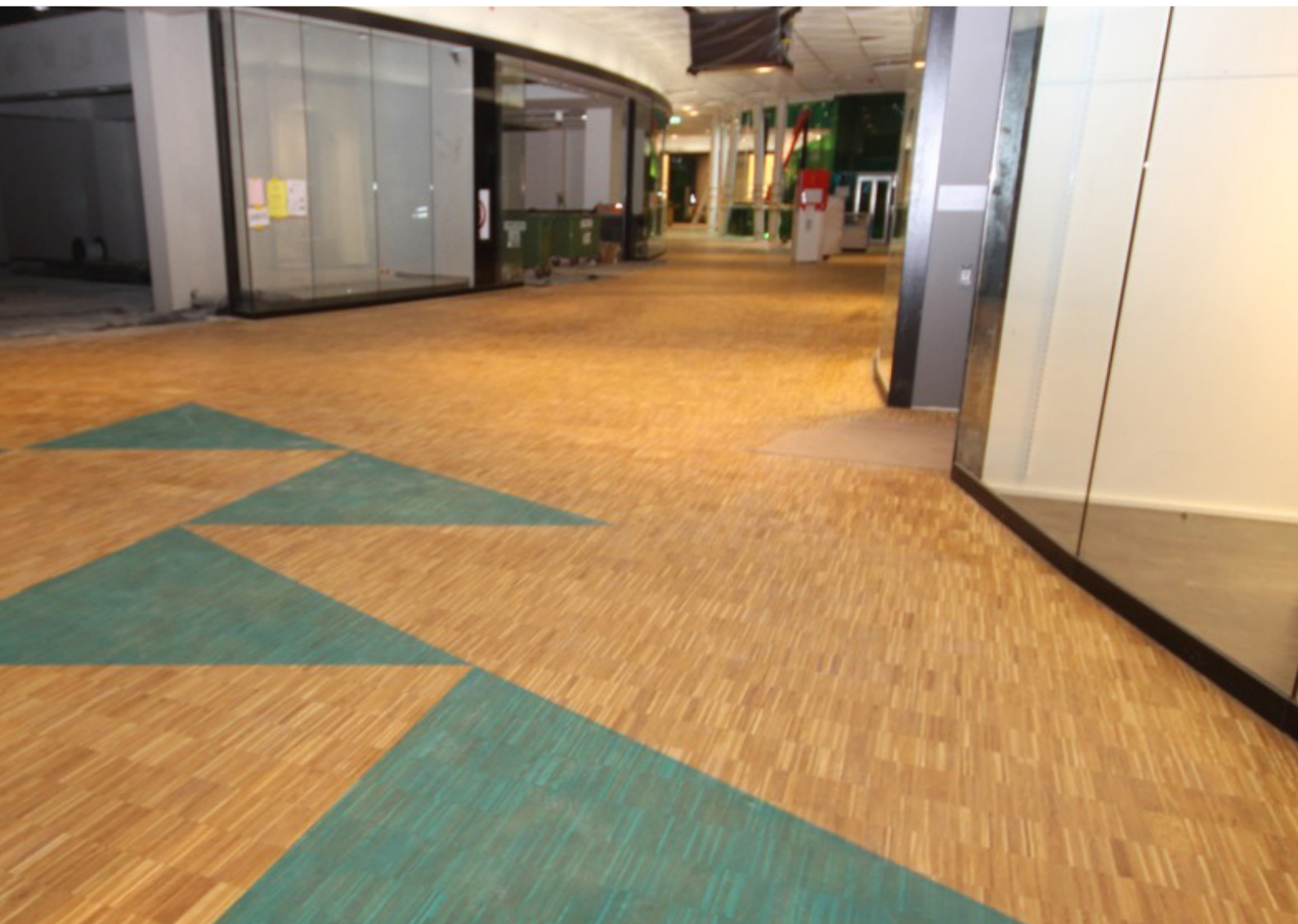
Emporia kjøpesenter i Malmø, ca. 6 000 kvm er slipt, innfarget og hardvoksoljet. Gulvene blir periodisk vedlikeholdt av Ångtvättbilen Malmø.
